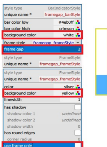
Abbildung 110: Der Abstand ( frame gap ) wird in der Hintergrundfarbe des Rahmenstils gezeichnet.
