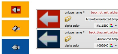
Abbildung 133: Buttons mit Alphafarbe auf farbigem Hintergrund, 1 und 3 mit dem selben Button-Stil (Alphafarbe von 1 geht verloren), 2 mit eigenem Button-Stil (alles OK)
