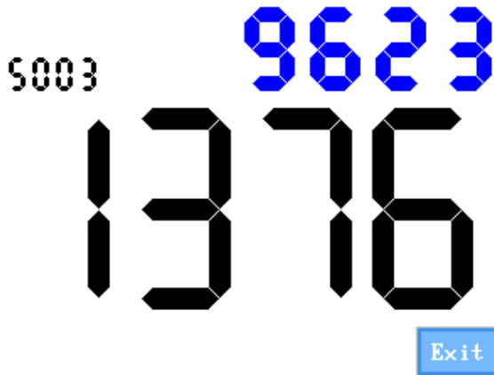
Abbildung 10: Beispiel für Sieben-Segmen-Anzeige
